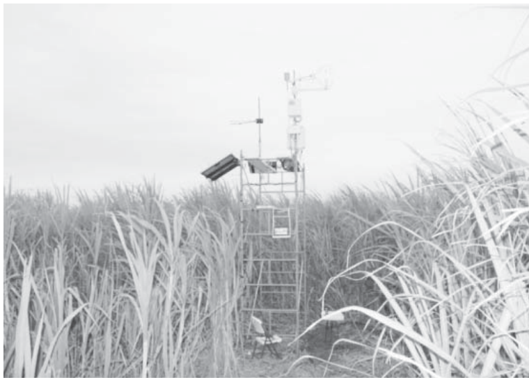
Figura 1. Sistema eddy para medir flujos de bióxido de carbono, vapor de agua, radiación neta y radiación fotosintéticamente activa sobre el dosel de un cultivo de caña de azúcar en Santa Anita, Xicoténcatl, Tamaulipas, noviembre de 2008
