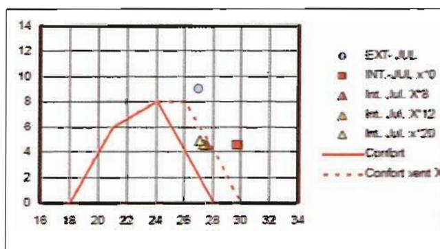
El triángulo indica también que el dormitorio este con un aislamiento de 5cm de fibra de vidrio y un triplay de 5mm clavado bajo la techumbre, como sustentación de la fibra y una mínima ventilación nocturna, permite ubicarse en la zona de confort de manera constante.
