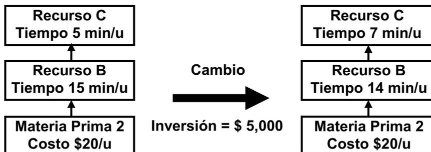
Figura 11.2 Diagrama con cambio en el proceso, ejemplo 3.
