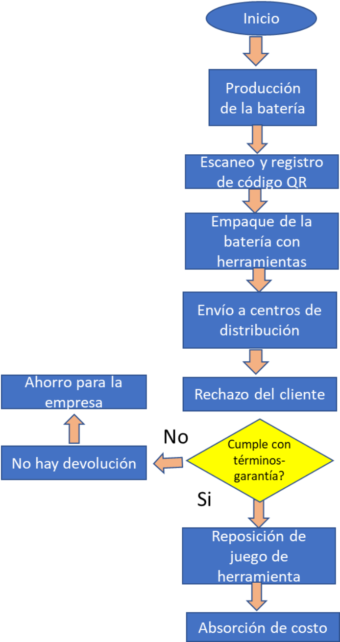
Figura 13. Mostrando el proceso conteniendo código QR, en un diagrama de flujo.
